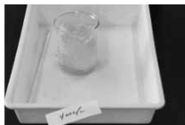
図3 4mol/L塩酸約50mL+チョーク約0.5本分での実験画像
