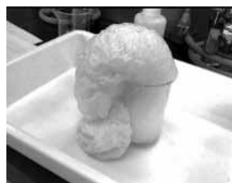
図1 6mol/L塩酸約50mL+チョーク1本での実験画像
