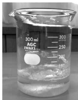
図5 3mol/L塩酸約50mL+チョーク0.1本分(約1g)での実験画像
