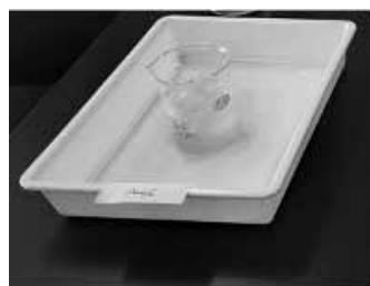
図2 3mol/L塩酸約50mL+チョーク約0.5本分での実験画像
