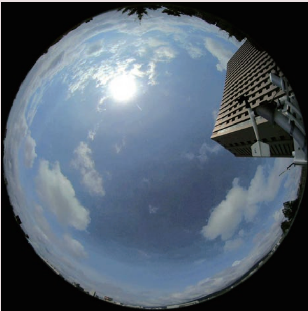
図4 魚眼カメラで撮影した天空画像を用いた雲移動予測
