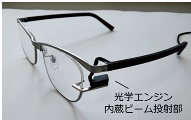
光学エンジンを搭載した眼鏡型ディスプレイの完成予定形状（モックアップ）
