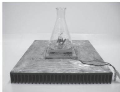
図3 ペルチエ素子利用による冷却装置
