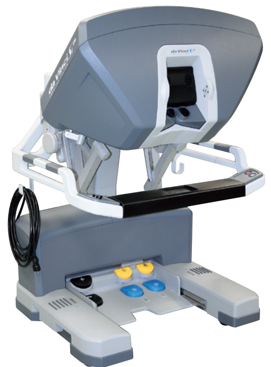
手術支援ロボット「ダヴィンチSi」サージョンコンソール
