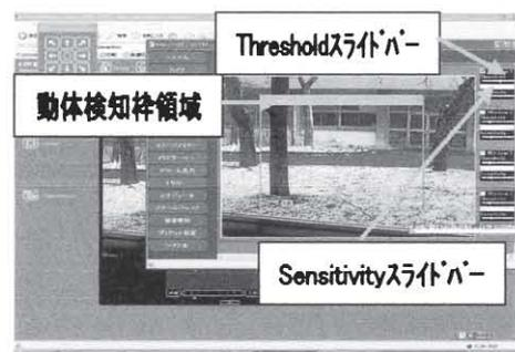
図2 動体検知設定と検知領域枠設定
