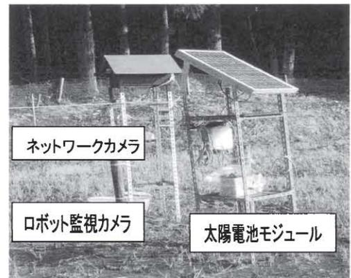
図4 ロボット監視カメラ装置
