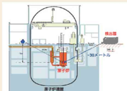
原子炉ニュートリノモニター概要図
