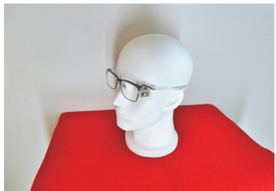
超小型光学エンジンを搭載した眼鏡型ディスプレイ試作品
