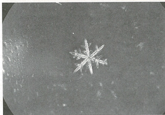
写真10：ビニールテープの表面のできる樹枝状型人工雪
