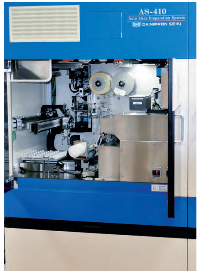
組織切片自動薄切装置 AS-410 (大日本精機株式会社)
