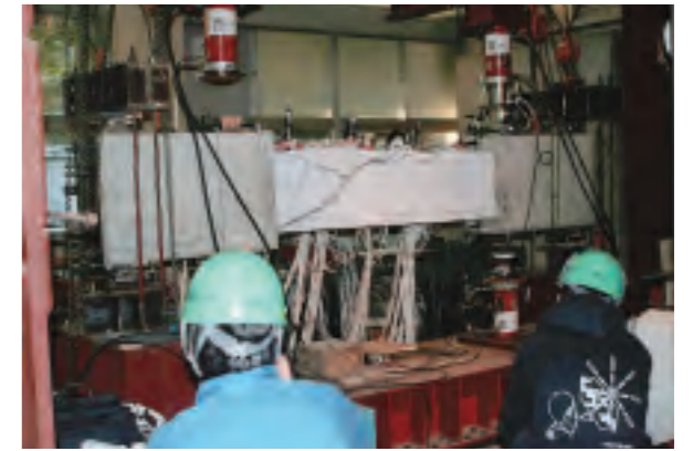
鉄筋コンクリート梁の載荷実験
