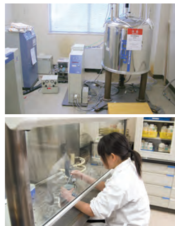
〔上〕NMR(核磁気共鳴分光装置) 超伝導磁石に入れた試料に電波を当てて原子核を検出。分子構造が測定可能な装置 〔下〕微生物・動物細胞の培養は、雑菌の混入を避けるため、クリーンベンチにて無菌操作します
