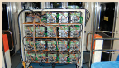
本学科で開発したリチウムイオン電池を用いた電車運転実験
