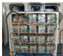
本学科で開発したリチウムイオン電池を用いた電車運転実験
