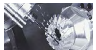
複合加工CNC旋盤(ヤマザキマザック社製IN-TEGREX 100-III S)による加工の様子
