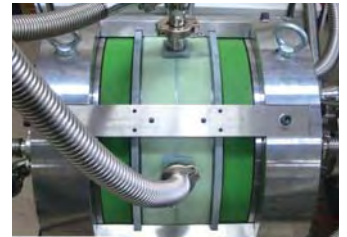
[上]全超伝導電動機 世界で初めての全超伝導・液体窒素冷却の電動機(パワーエレクトロニクス研究室) [左]デバイス特性評価装置 窒化物半導体を用いた新構造トランジスタの基本特性を測定(電子デバイス研究室)
