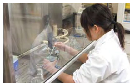
〔上〕NMR（核磁気共鳴分光装置） 超伝導磁石に入れた試料に電波を当てて原子核を検出。分子構造が測定可能な装置 〔下〕微生物・動物細胞の培養は、雑菌の混入を避けるためクリーンベンチにて無菌操作します
