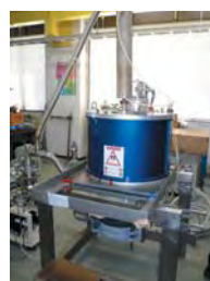
[上] 電磁波によるセラミックス焼結装置。周波数28GHzおよび24GHz。新機能材料の開発研究で活用します [右] CW（定常発振）ジャイロトロンFU CW II。周波数400GHz、タンパク質の構造解析に用います
