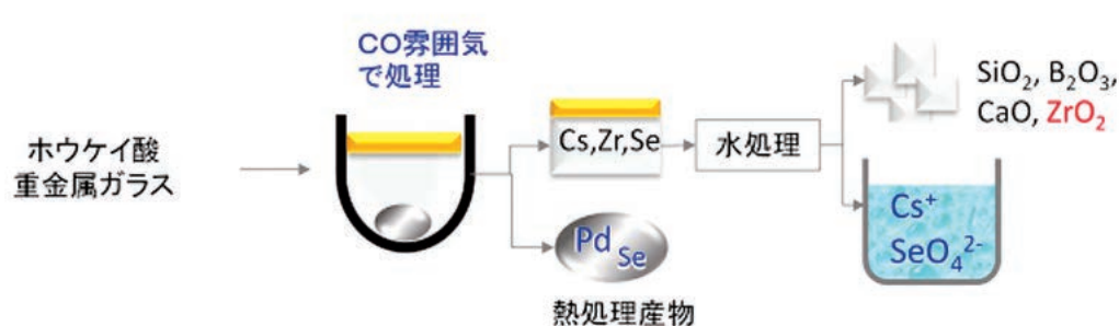
図1 フィージビリティスタディより構築したLLFP回収プロセスのフロー
