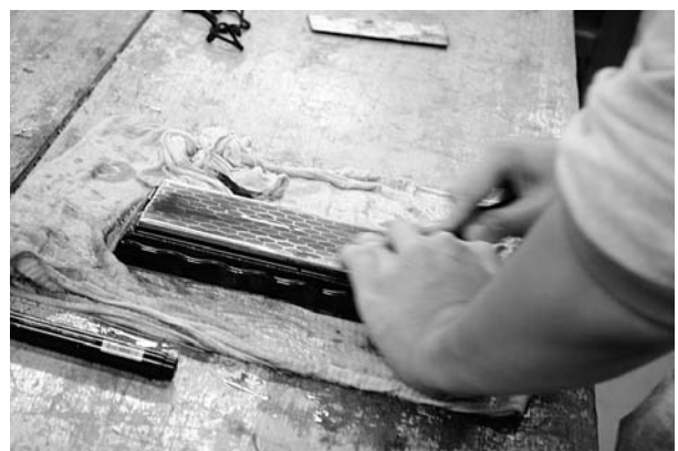
図13. ダイヤモンド砥石を使用すると、粗く大きく刃物を削り落とすことができる。
