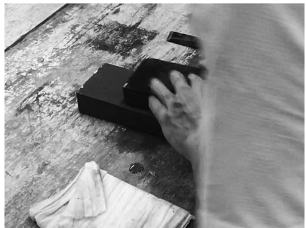
図12. 砥石を平滑に保つために3個の砥石を使い、輪番で相互に研磨する事により3個の砥石の平滑面が得られる。ここでの砥石面が刃物を形作る基準となる。
