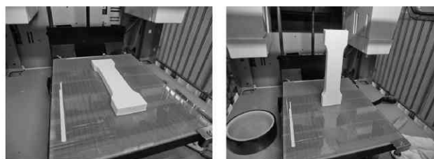
図 2.5 引張試験片 (左：横積層, 右：縦積層)
