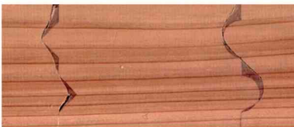
図9 ずれを黒く塗りつぶした試験片
