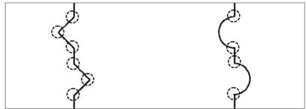
図13 ずれ面積増大の発生が多い箇所
