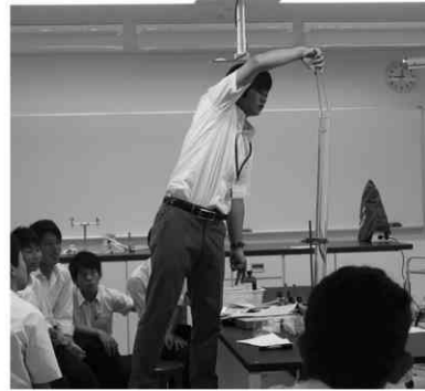
図9. 高さ1m、直径5cmの水の入ったアクリルパイプ中にペットボトルのラベルを落とす様子
