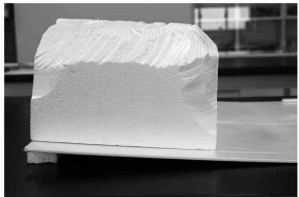
図 4：実験装置側方 発泡スチロールブロックで傾斜(約4°)をつけた
