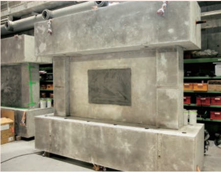
PVA繊維が入ったモルタルを吹き付けて補強した例
