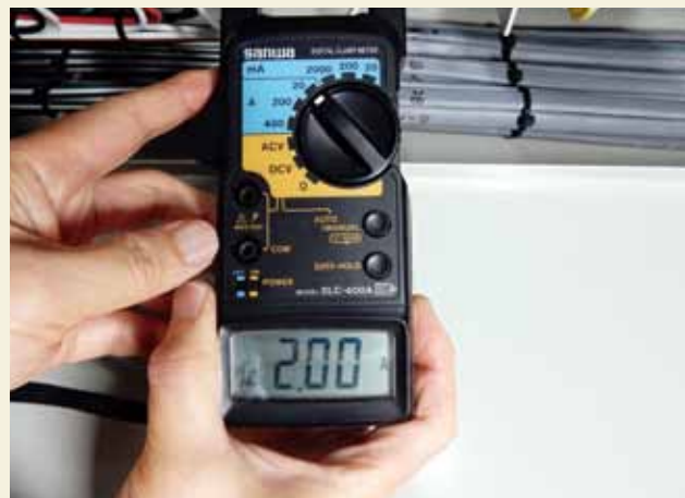
改修後の電流値2A 電圧200Vなので消費電力400W
