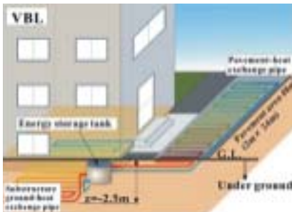
Fig.1 建物基礎地中熱採集 (SGHC) システム
