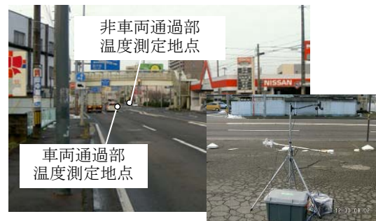
図2 信号部における乾燥路面温度測定地点と気象観測
