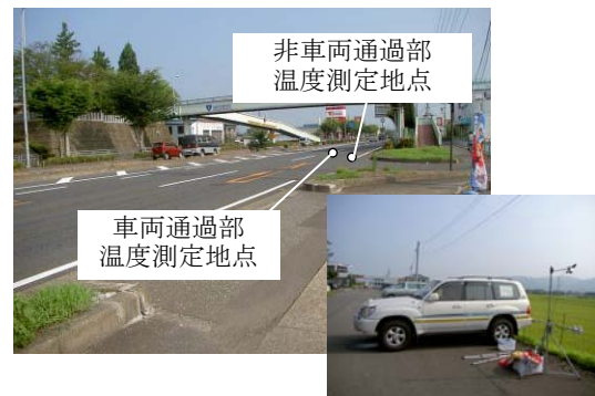
図1 自然走行部における乾燥路面温度測定地点と気象観測
