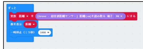
図 14 超音波センサを使用するプログラム
