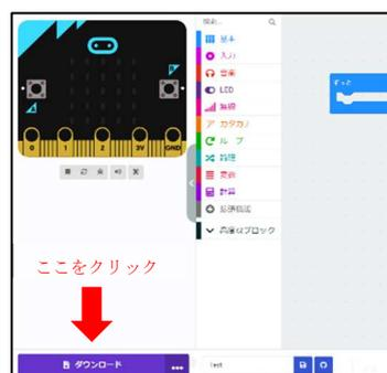
図11 micro:bit でのプログラムの書き込み
