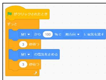
図 6 M1 に電圧を出力するプログラム
