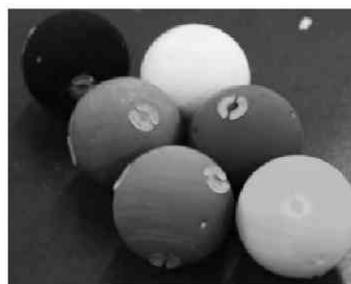
写真4 小型ソケットを埋め込んだディンプル付 30mm 発砲スチロール球
