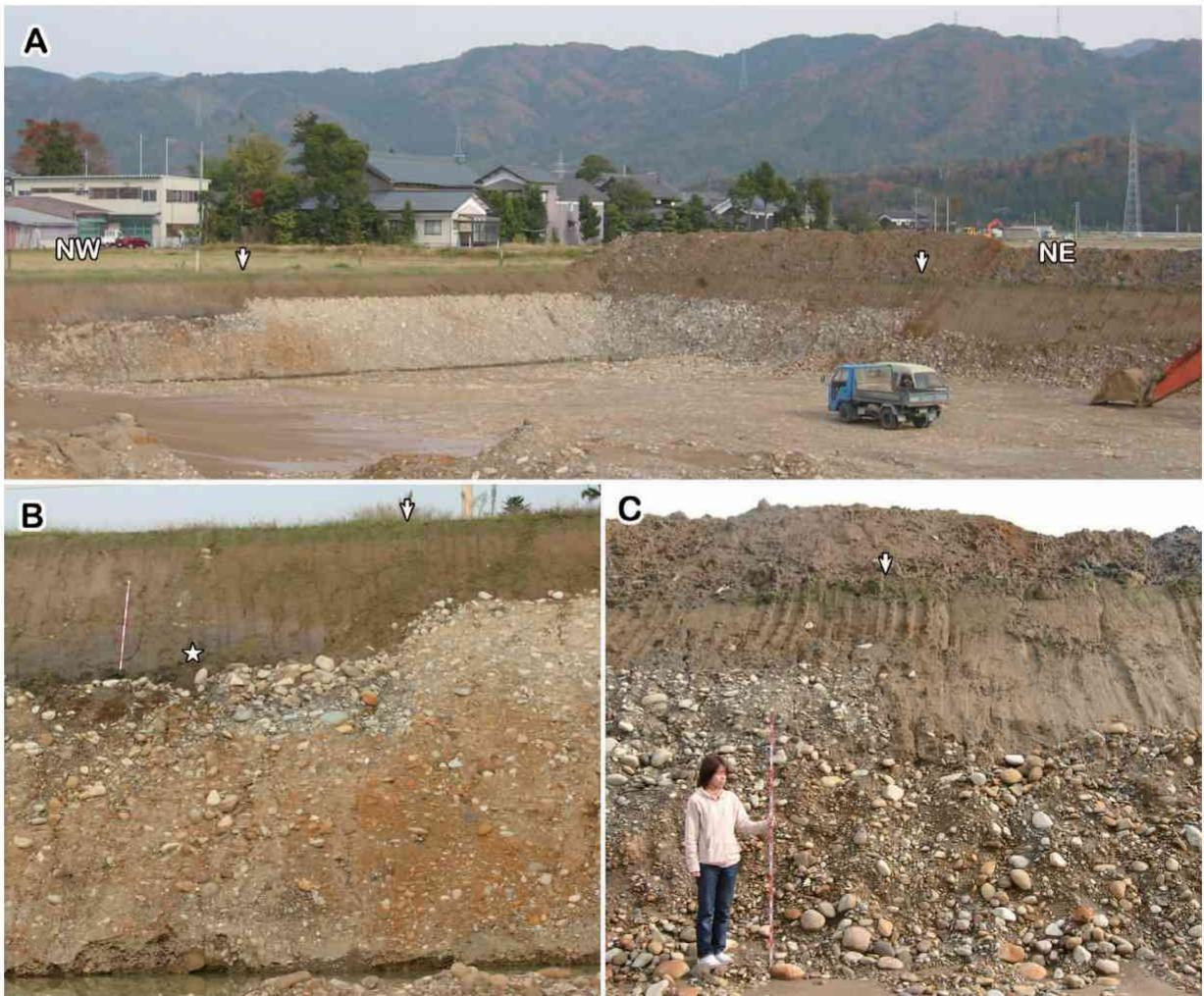
図 11. 福井東側地震断層沿いの土砂採取場で見られた断層露頭. A: 北西側と北東側に礫層のずれ (矢印) が認められ, 2 つのずれの位置を結んだ断層の走行は  $N18^{\circ}W$  である. B: 北西側の断層露頭. 泥炭質な砂層から木片を採取 (☆地点). C: 北東側の露頭.
