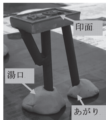
図2. 湯道を付けたろう型
