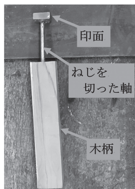
図9. 完成した焼印
