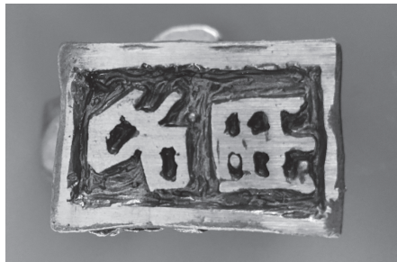
図8. 成型後の印面
