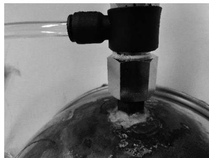
図5 継手ろう付け部
