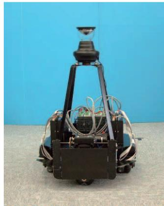
図-12 ノート PC の採用により低重心化した4輪バージョン(黒いカバーを外して撮影。2005年大阪大会から使用)
