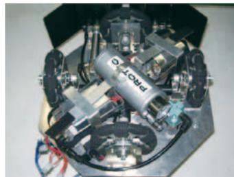
図-10 4車輪4モータの例(スペースができたのでキック用のエアシリンダを配置している)
