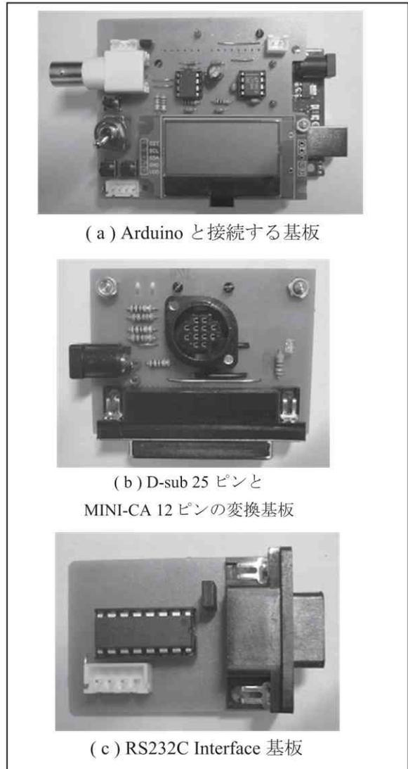
Fig.6 作製した回路基板
